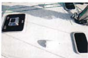
Aan dek zijn twee luchthappers van een vrij onbekend model. Die mogen wel wat steviger. Op het luik staat een permanente ventilator die aangedreven wordt door een zonnecel.
