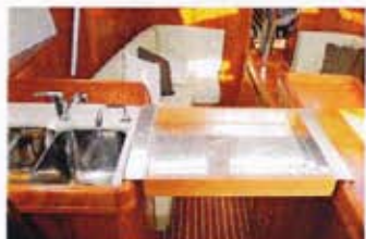
Met deze wegneembare druijbak valt het werkoppervlak te vergroten.
