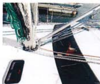
Alle lijnen aan de mastvoet lopen via geleideblokken naar de kuip.
